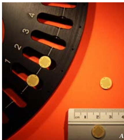
5 - Porta-amostras do leitor de luminescência (A); Disco para grãos individuais (B); Pormenor do disco com grãos de quartzo (C).
