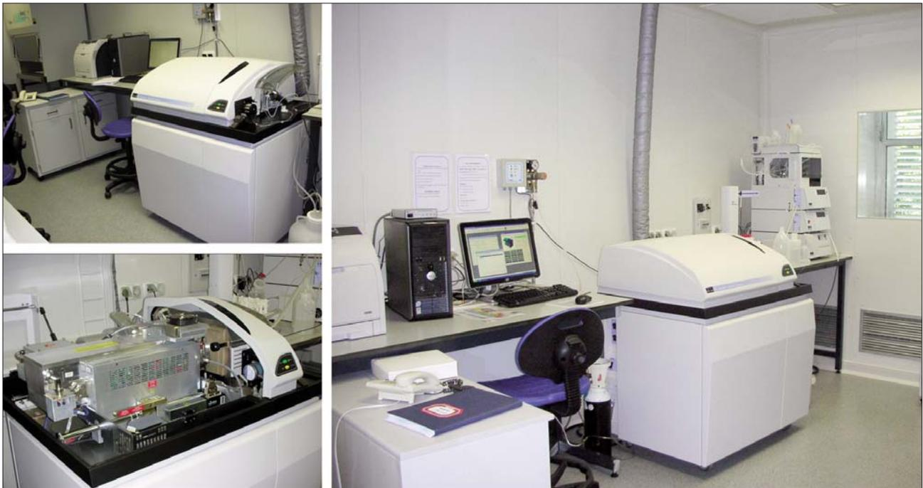
**FIG. 8** – Espectrómetro de massa com ionização acoplada por plasma (Perkin- Elmer, ELAN DRC-e).
