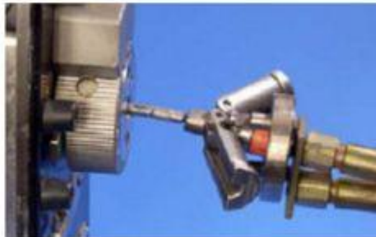
Operação de conexão da fonte de Ir-192 - Fase 2
